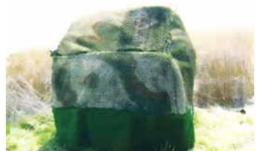
● รูปภาพแสดงให้เห็นถึงยานพาหนะที่ถูกคลุมด้วยตาข่ายพรางยุทธวิธี HYO WON ประเภท C จะไม่สามารถถูกค้นพบได้ด้วยภาพสะท้อนของความร้อน โดยภาพแสดงความร้อนจะกลมกลืนไปกับสภาวะแวดล้อมโดยรอบ
